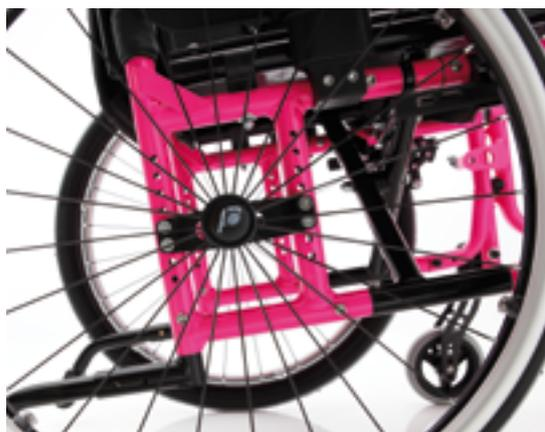
Regolazione altezza e assetto ruota posteriore e sistema antiribaltamento (standard).
